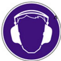
1. Angebracht auf dem Maschinengehäuse, hinter dem Motor: „Gehörschutz vorgeschrieben“
