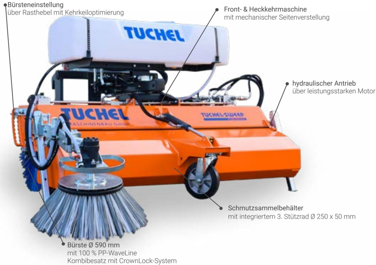
Die Front- und Heckkehrmaschine Plus 590 Pro ist ein wahres Multitalent und für fast jedes Trägerfahrzeug geeignet.
