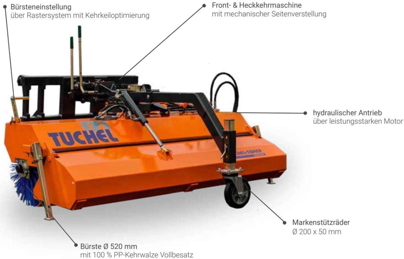
Die Front- und Heckkehrmaschine ECO Pro kann durch ihre verschiedenen Arbeitsbreiten an Traktoren, Hoflader und kleine Gabelstapler angebaut werden.
