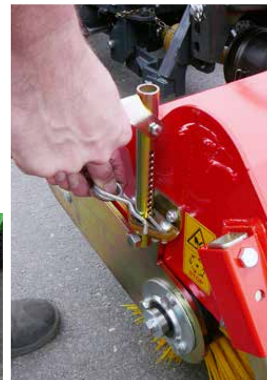
Réglage des brosses par système d'enfichage
