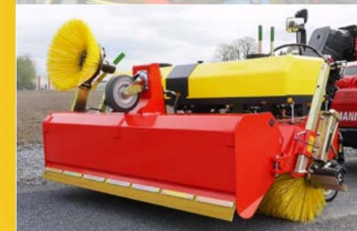
Mode de balayage simple, vidage hydraulique et troisième roues de support du bac collecteur
