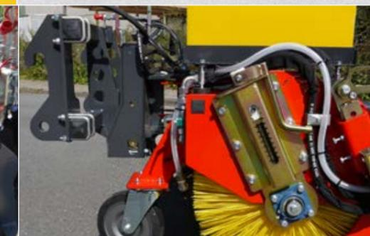
Attelage pour chargeuse sur roues avec compensation de niveau avec glissière à roulements à billes
