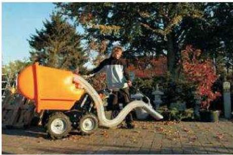
Der Sauger wird an Stelle der Mulde auf dem Muck-Truck installiert. Sein Kawasaki Benzinmotor ermöglicht kraftvolles Saugen durch den ca. 3 m Ansaugschlauch.
