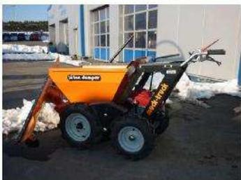
Auf sensiblen Rasenflächen setzen wir auf dem Muck-Truck die Rasenschonbereifung ein. Die Rasenschonbereifung hinterlässt selbst bei voll beladener Maschine keine Spuren.
