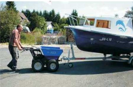
Die Anhängerkupplung wird einfach an der Maschine angebracht. Sie eignen sich zum Rangieren von Anhängern, Hebebühnen, Hächslern, Betonpumpen, Wohnwagen, Bootstrailern u.s.w. Auf ebenen, griffigen Untergrund können Hänger bis zu 5 Tonnen bewegt werden. Um den Bodendruck und die Kippgefahr zu verringern und die Traktion im schwierigsten Gelände noch wesentlich zu erhöhen bieten wir als Zubehör, Zwillingräder an.
