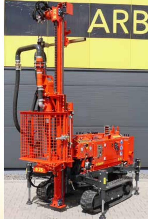
ADLER-Bohrgerät auf ADLER-Raupenfahrwerk
