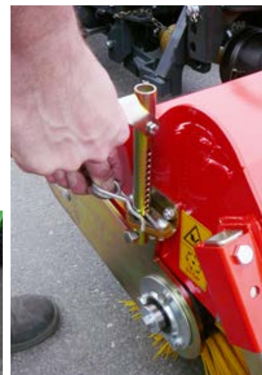
Bürstenverstellung über Stecksystem
