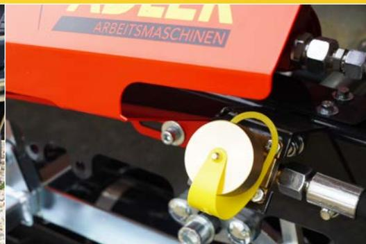
Seitlicher Füllstutzen für LPG-Autogas
