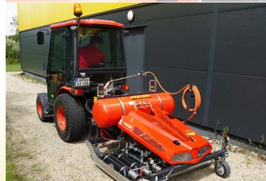
Der Einsatz ist sowohl im Front- als auch Heckbetrieb möglich.
