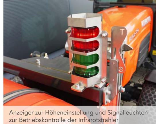
Anzeiger zur Höheneinstellung und Signalleuchten zur Betriebskontrolle der Infrarotstrahler
