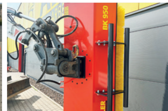
Einsatz für den vertikalen Gebrauch mit Powertiltfunktion am Bagger
