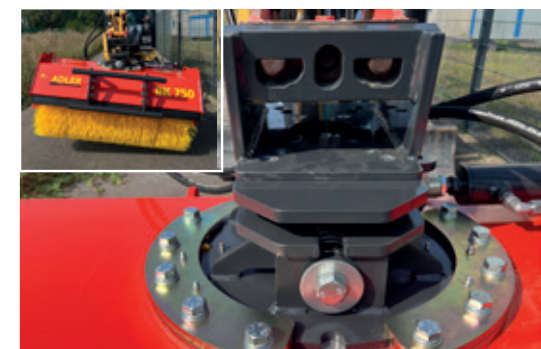
Federbelastetes Pendel passt sich dem Untergrund optimal an.
