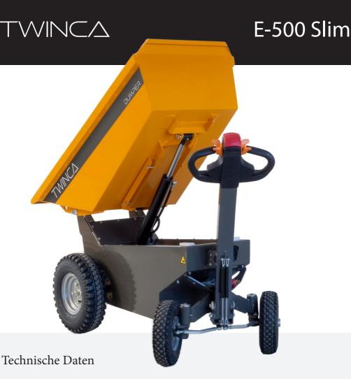
Maße: Leistungsfähigkeit: Spezifikationen: Ladungsvol.: Gewicht: 264 kg Länge: 1744 mm 250 Liter Geschwindigkeit: Breite(4): Ladungsgewicht: 0-6 km/h 742 mm 500 kg 3 PS (2,2 kW) Höhe: 955 mm Leistung: Kipppunkt: 970 mm Batterie: Anzeige: LED Anzeige Entladungshöhe: 520 mm Volt: 2x12 V Kippmechanismus: Ia Höchster Punkt Amperestunde: 80 Ah Hebebühne: Nein gekippte Ladefl.: 1926 mm Betriebszeit: 8 Stunde
