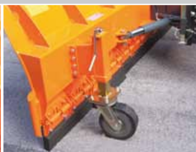
Roues de soutien et de guidage réglables en hauteur
