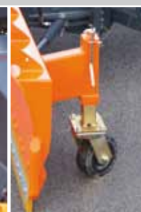
Roues de soutien et de guidage, réglables en continu
