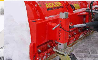
Roues d'appui réglables en hauteur (200 x 80 mm)
