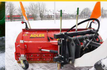
Attelage universel avec rotation hydraulique (avec deux vérins hydrauliques)
