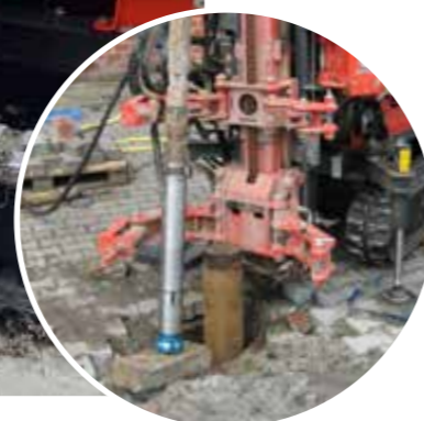
3" Imlochhammer mit Bohrkronen
