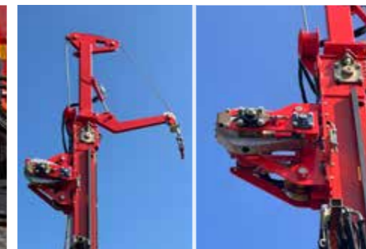
Mastkrone mit Seilschlageinrichtung
