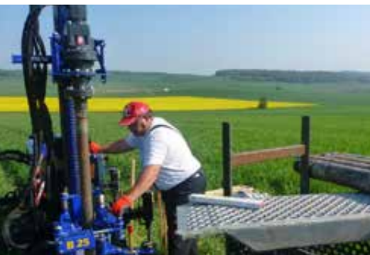
Bohrgerät B 25 im Einsatz beim Kerne ziehen
