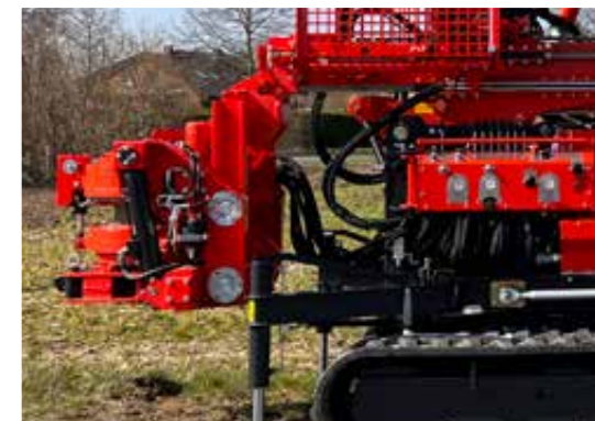
Verrohrungsdrehtisch in Transportstellung
