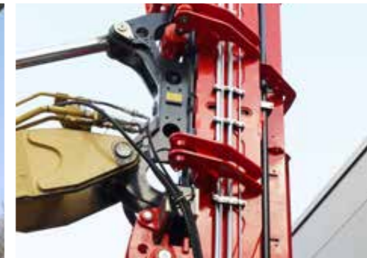
Aufnahme der Bohrlafette über Bolzen
