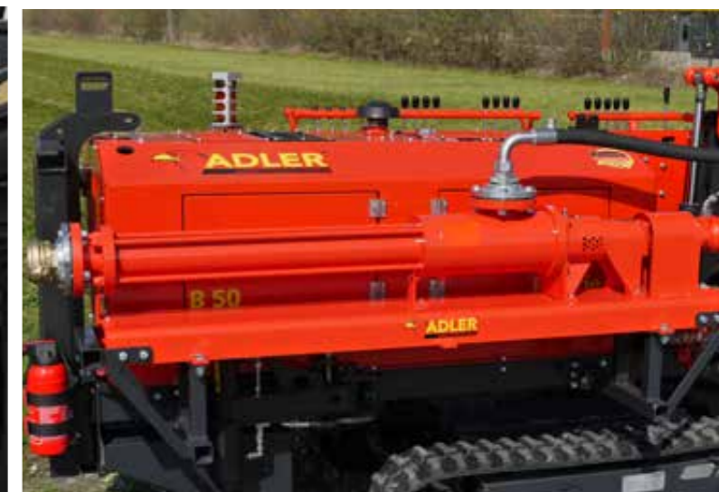
Schneckenpumpe im Einsatz beim Doppelkernrohrbohren
