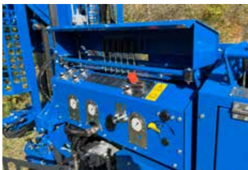
Bedienstandschutzhaube mit Beleuchtung
