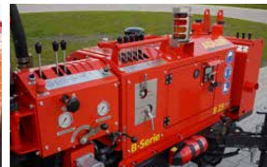
Bedienstand mit allen Bohrfunktionen – schwenkbar
