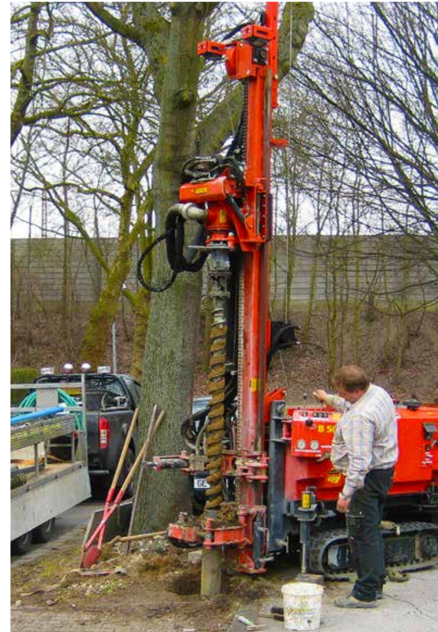
B 50 mit Trockenbohrausrüstung ist aufgrund seiner kompakten Bauform auch in beengten Verhältnissen einsetzbar
