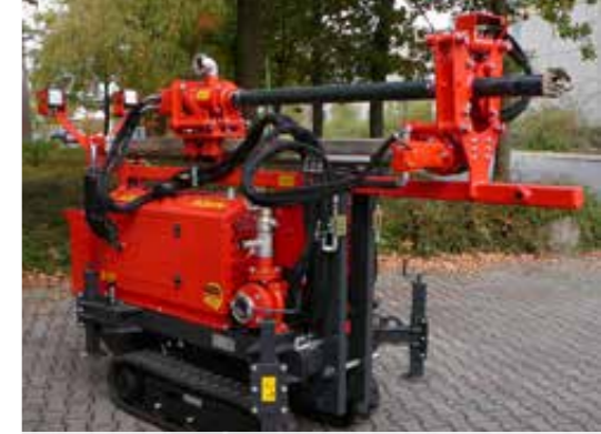
B 15 das kompakte Bohrgerät für oberflächennahe Teufen
