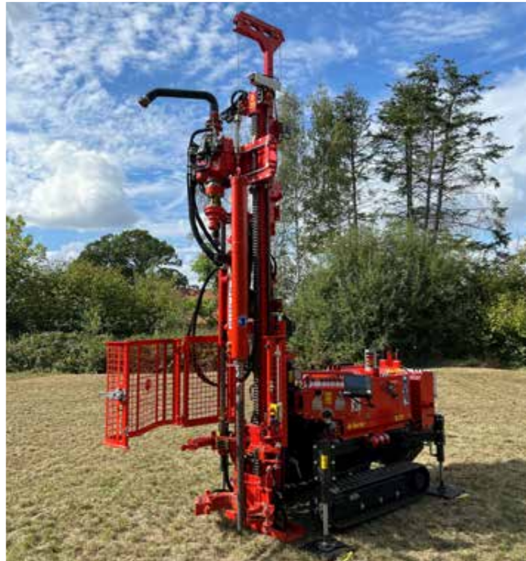
B 25 ausgerüstet mit Rammsondiereinheit
