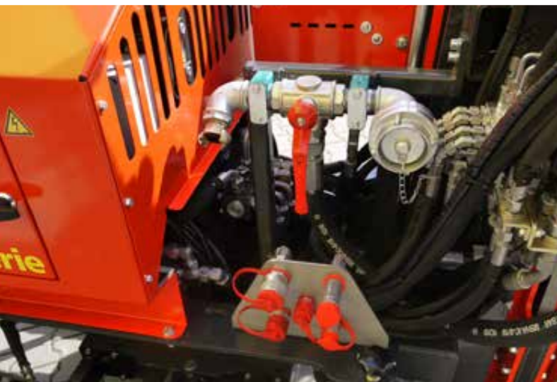
Umschaltung von Wasser auf Druckluft und zusätzliche hydraulische Anschlüsse für Zubehör
