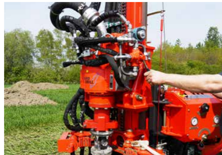
2-stufiger Bohrantrieb mit Drehmomenten bis zu 620 daNm oder Umdrehungen bis zu 210 U/min
