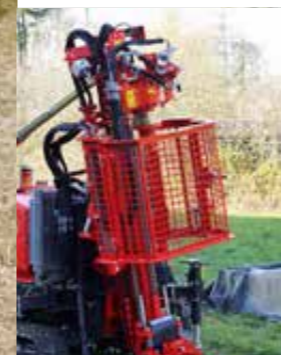
Seitliche Neigung des Bohrmastes (optional)
