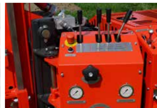
Steuerstand zur Betätigung des Bohrkopfes
