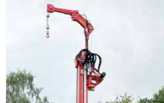
Seilwinde mit Seilschlageinrichtung und Mastverlängerung
