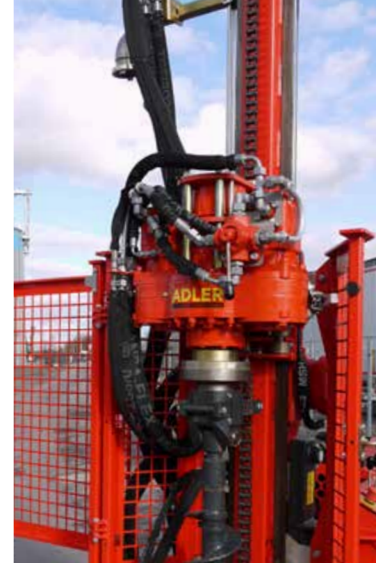
Getriebebohrkopf mit zwei Schaltstufen
