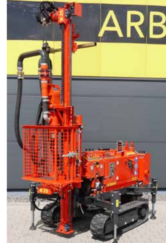
ADLER-Bohrgerät auf ADLER-Raupenfahrwerk
