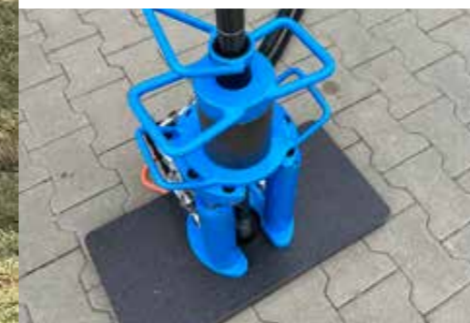
Hubeinheit mit Kugelklemme zum Ziehen der Ramm- oder Rammkern-Werkzeuge (120 kN Hubkraft)
