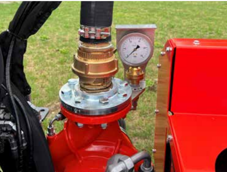
Spülpumpe mit Spüldruckanzeige
