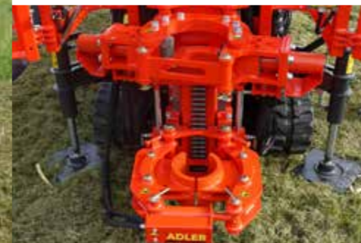
Klemm-Brech-Hubschelle bis 11,8 Tonnen Zugkraft
