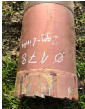
Rohrschneidschuh für Aussenverrohrung Ø von 152 mm bis 324 mm
