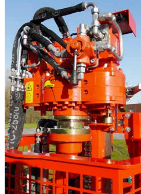
2-stufiger hydraulischer Bohrkopf mit Durchgang 2 1/2"
