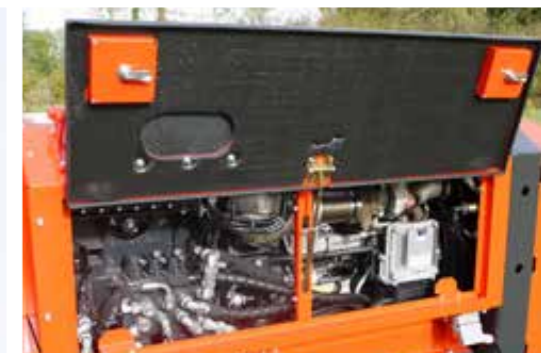
Bohrgerät B 75 ausgestattet mit 75 PS und 2,9 Liter Deutz-Motor der neuesten Abgasstufe 5
