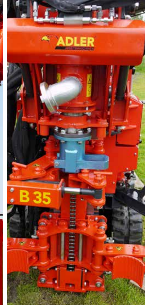
Spülbohrkopf, Brechvorrichtung, hydraulische Klemme und Hubspannschelle
