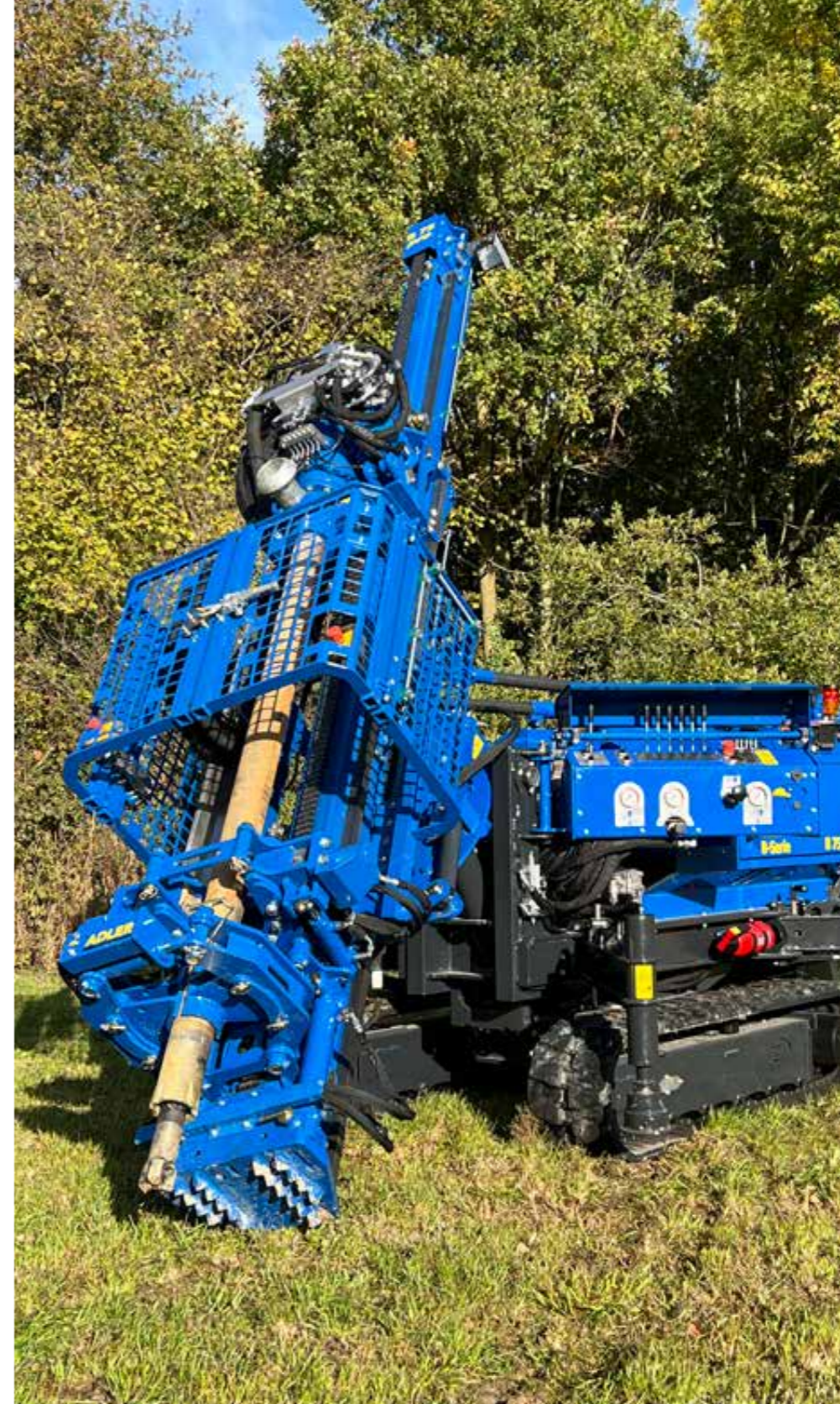
B 75 mit 3D Schrägeinrichtung inkl. zwei Mastabstützungen
