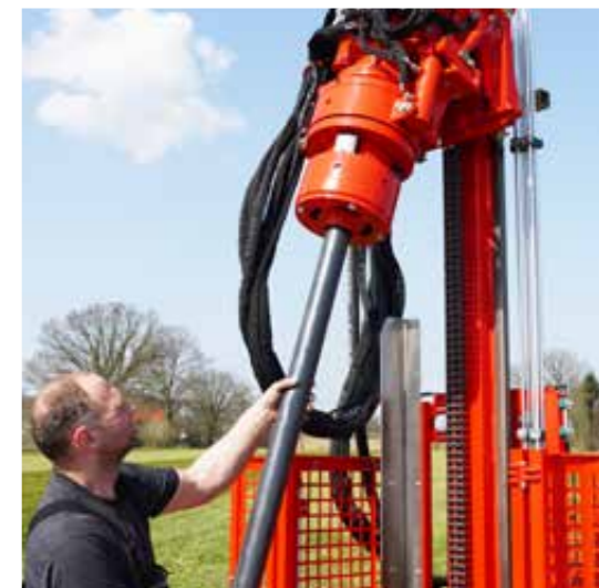
Hydraulische Spannglocke (groß) zum Brechen des Bohrgestänges und zum Brechen der Aussenverrohrung bis 178 mm
