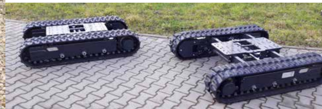
Die Fahrwerke können wahlweise starr oder hydraulisch teleskopierbar gefertigt werden.
