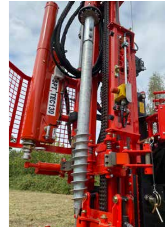
Zum Eindrehen von Schraubfundamenten
