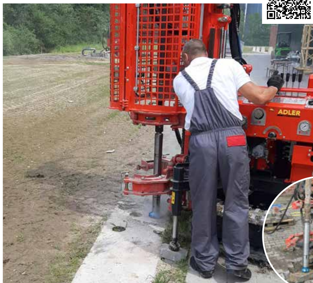
B 50 mit Imlochhammerausrüstung
