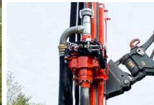
Aufnahme der Bohrlafette über den Schnellwechsler des Baggers
