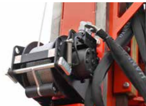
Seilwinde mit 500 kg oder 1.000 kg Zugkraft
