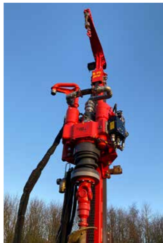
Getriebebohrkopf mit Floatingspindel am B 75 pro
