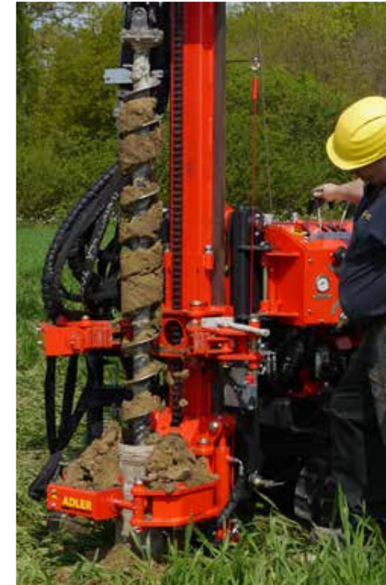
Einfache Ansteuerung der Bohrschnecke über den Steuerstand
