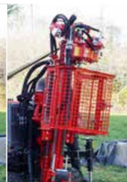
Seitliche Neigung des Bohrmastes (optional)
