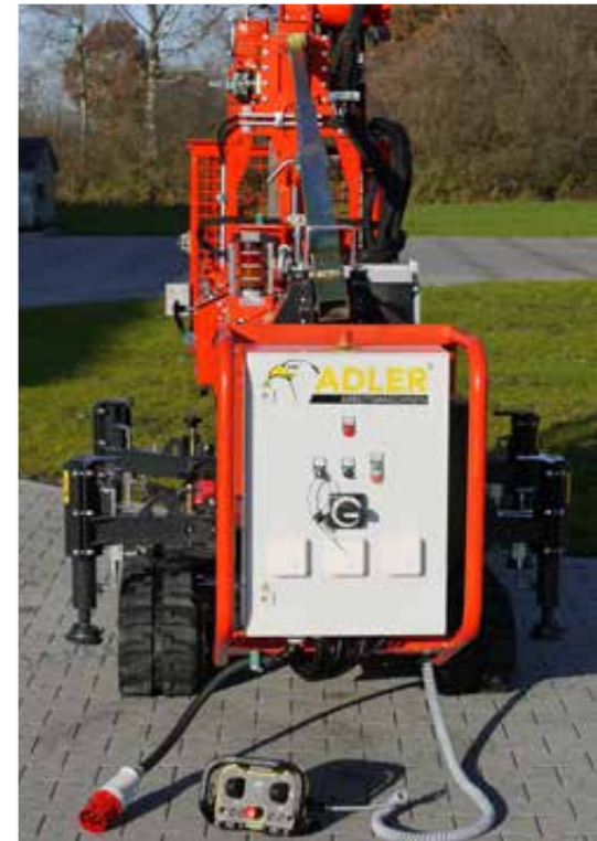
Elektroschaltschrank mit drei CEE Steckdosen (Ausgang)
