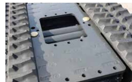
Das Mittelstück des Fahrwerkes verfügt über viele Anschraubpunkte, die kundenspezifisch genutzt werden können.
