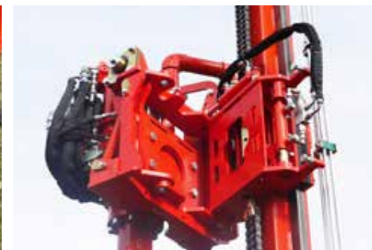
Hydraulische Verschwenkung des Bohrkopfes aus dem Bohrzentrum
