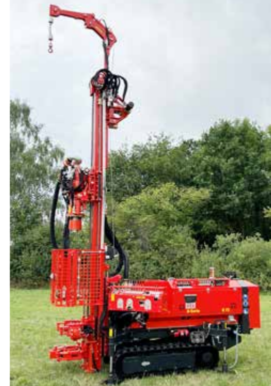
Ausschwenkbarer Getriebebohrkopf mit durchgehender 2 1/2" Spülwelle
