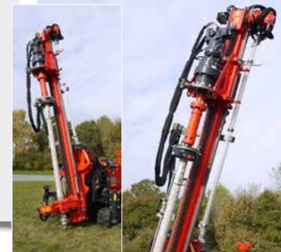
Variabler Bohrkopf mit bis zu 8.000 Nm und mit Schnellwechsellvorrichtung
