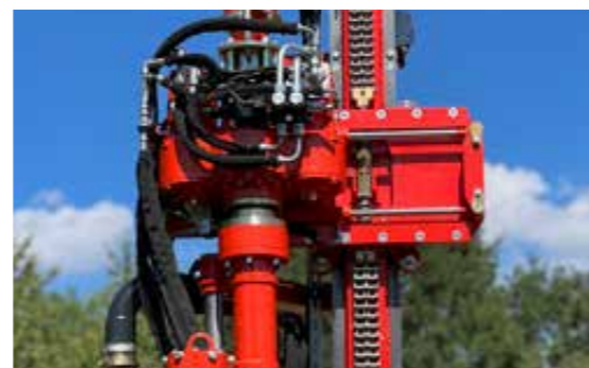
Seitenverschiebung Bohrkopf bei B 25
