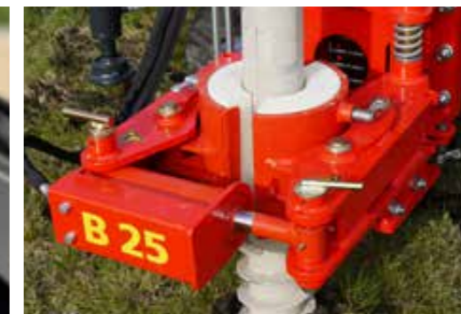
Hydraulische Klemme zum Führen der Schraubfundamente
