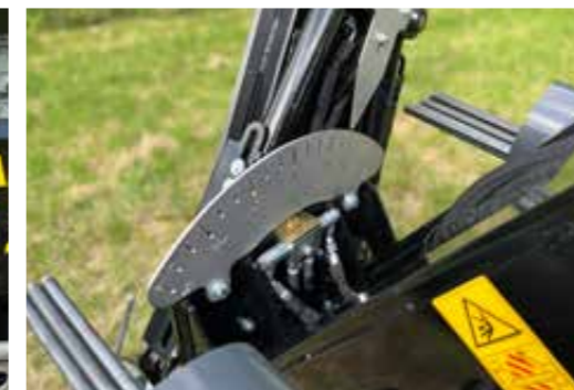
Winkelmeßeinheit für schräges Schlagen
