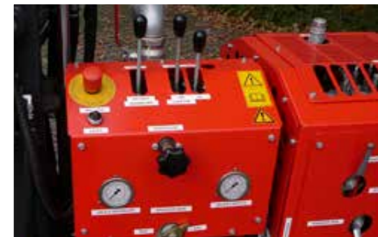
Bedienstand zur Steuerung des Bohrprozesses
