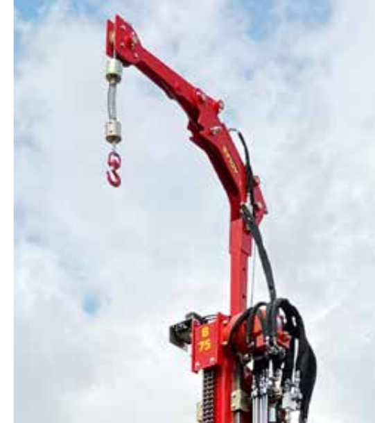
Seilwinde mit Seilschlageinrichtung und Mastverlängerung
