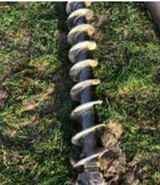
Bohranfänger mit Enloschnecke von 80 mm bis 324 mm erhältlich
