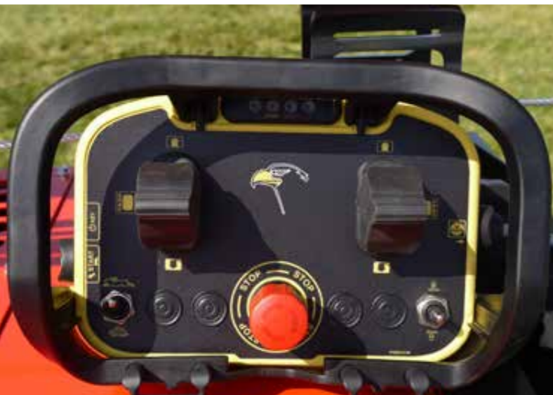
Kabelfernbedienung für den Fahrbetrieb
