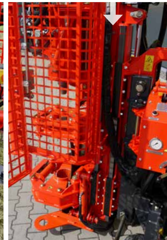
Hydraulische Mastabsenkung 300 mm beim B 50, B 75 und B 75 pro
