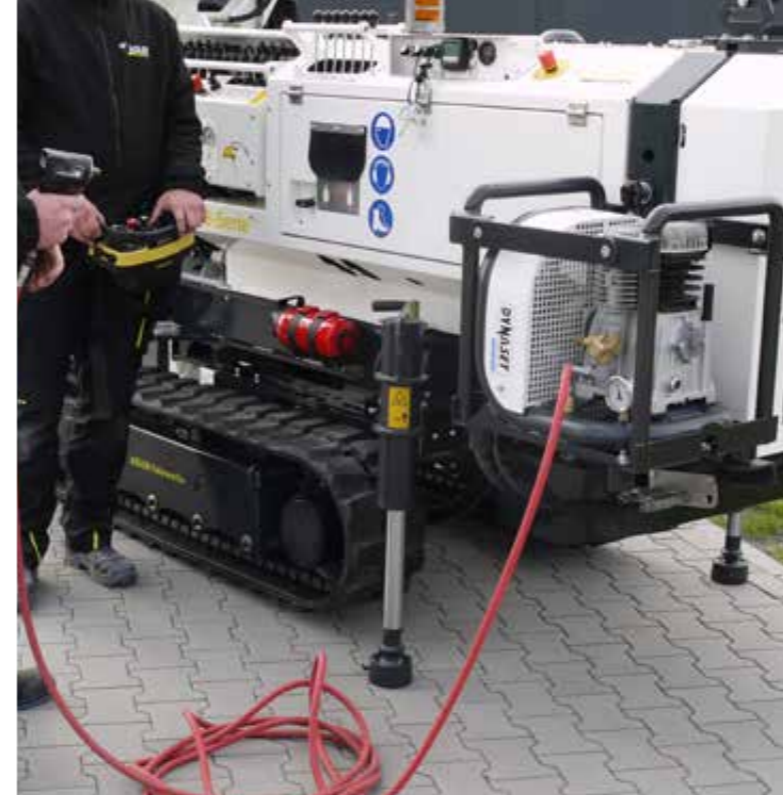
Luftkompressor – Antrieb über das Bohrggerät
