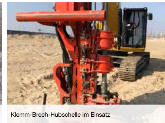
Lafettenfuß als Klemm-Brech-Hubschelle ausgeführt
