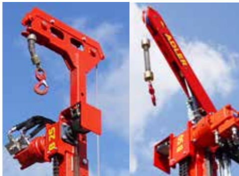
Mastausleger starr oder hydraulisch für die Seilumlenkung
