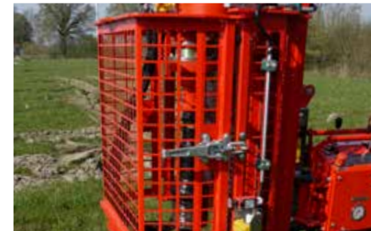
Schutzeinrichtung im Bereich des drehenden Gestänges serienmäßig
