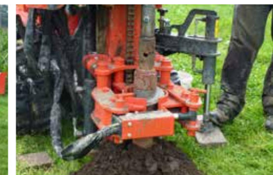
Hohlbohrschnecke durch die Hubspannschelle geführt
