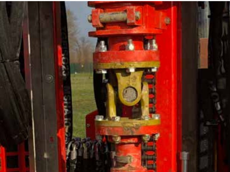
Kreuzgelenk mit BOM 73,5 oben, SW 41/51 unten
