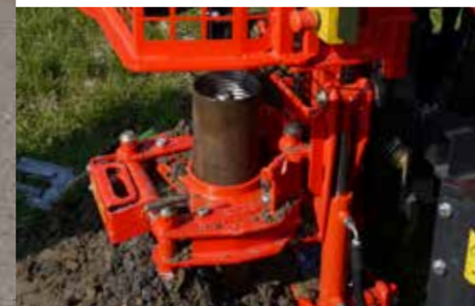
Optional beim B 25: Hubspannschelle für verrohrtes Bohren
