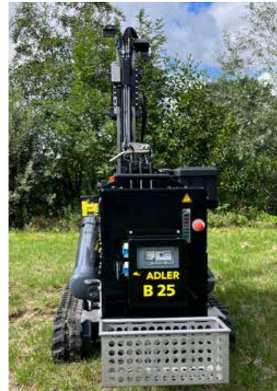
Ausgestattet mit Werkzeugkiste und Transportbehälter für Erdungsstangen
