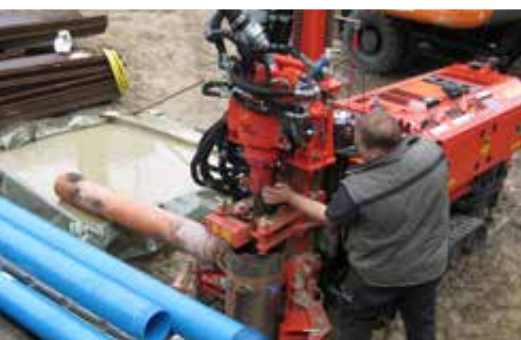
Brechvorrichtung im Zusammenspiel mit hydraulischer Klemme – serienmäßig bei allen Modellen der B-Serie
