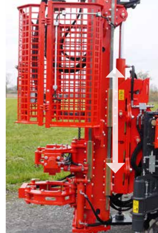
Mastabsenkung um 300 mm beim B 75 pro serienmäßig
