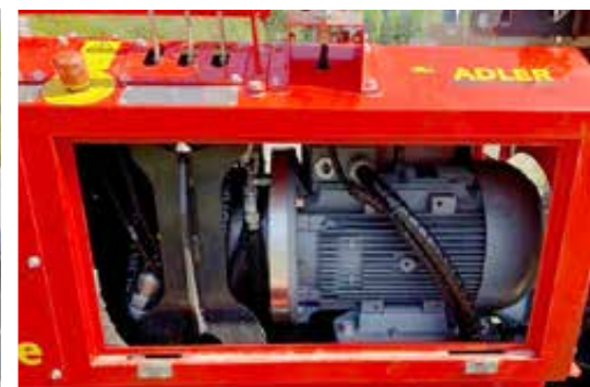
Emissionfreudlicher Elektromotor 18,5 kW - 380 V - 3.000 U/min
