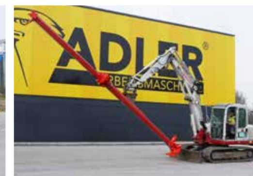
Anbaubohrlafette im Bohrprozess am Bagger
