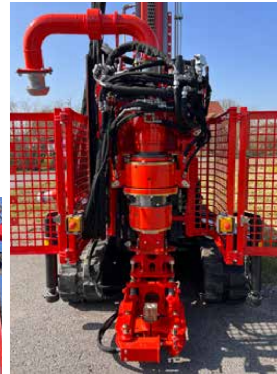
ADLER B 75 geo pro mit Saugbohrausrüstung
