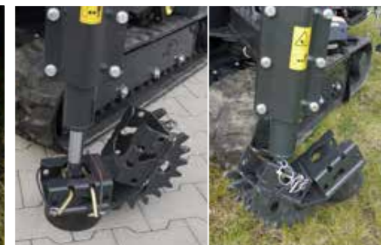
Stützfußschuhset für Gras und Halle mit Antirutschsystem
