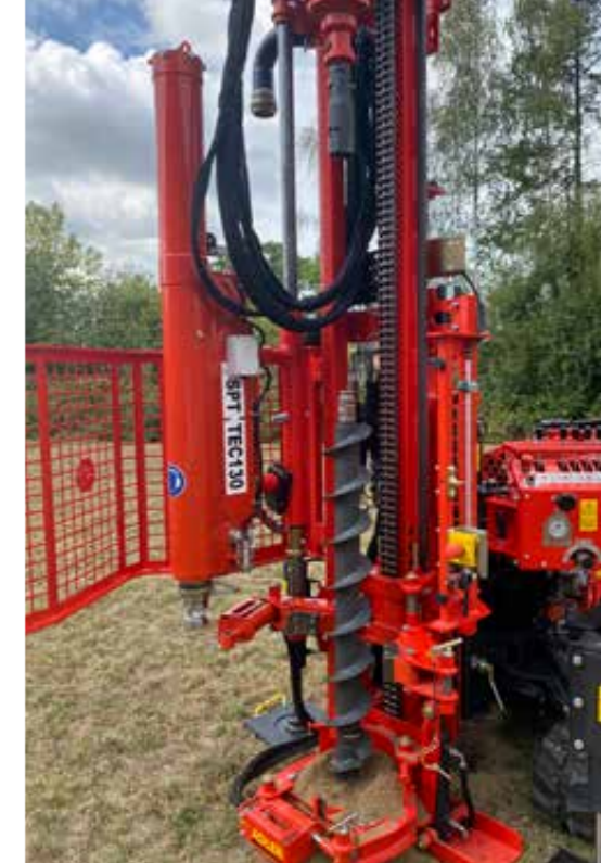
Sondierbohrung mit Hohlbohrschnecke oder Rammsondierung können im Wechsel durch Einschwenken der Rammsondiereinheit durchgeführt werden
