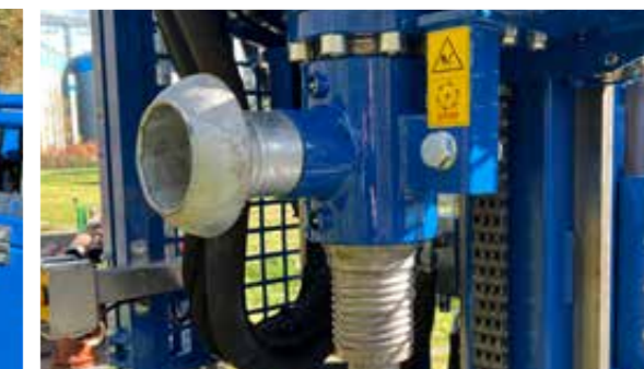
Kopfpreventer mit seitlichem Auslass
