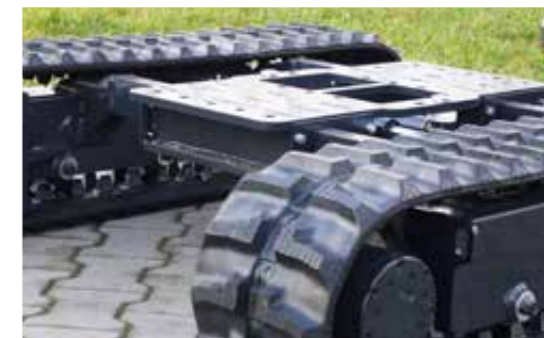
Eine stabile Stahlbauausführung sorgt für eine lange Lebensdauer der Fahrwerke.
