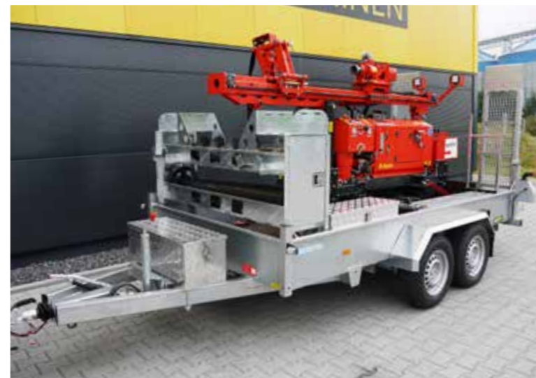
Bohrgerätetransportanhänger: Leergewicht 560 kg und zulässiges Gesamtgewicht 3.500 kg, inkl. Auffahrampen
