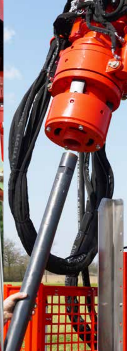
Hydraulische Spannglocke (groß/klein) und zum Brechen des Bohrgestänges und der Aussenverrohrung bis 178 mm (nur mit großer Spannglocke möglich)
