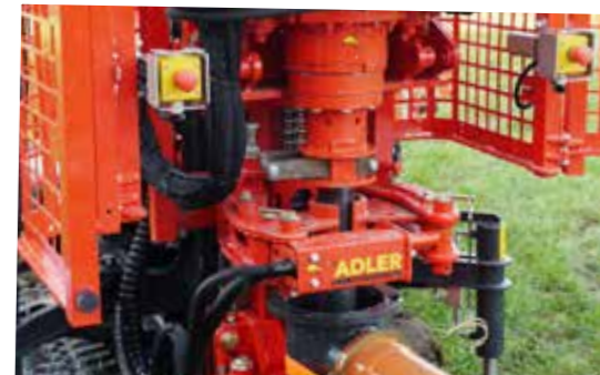
Hubspannschelle und hydraulische Gestängebrechklemme
