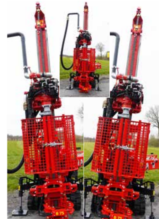
3D-Mastneigung um 5° (nach vorne, oben/unten und seitlich) serienmäßig
