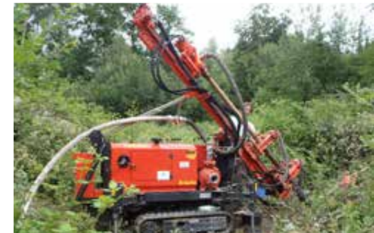
B 25 mit Schrägbohrereinrichtung
