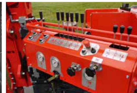
Ausschwenkbare Bedienpult zur Steuerung aller wichtigen Bohrfunktionen
