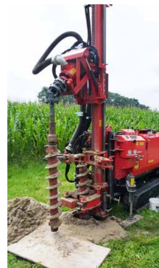
Einfaches Ausbauen der Hohlbohrschnecke durch schwenkbaren Bohrkopf
