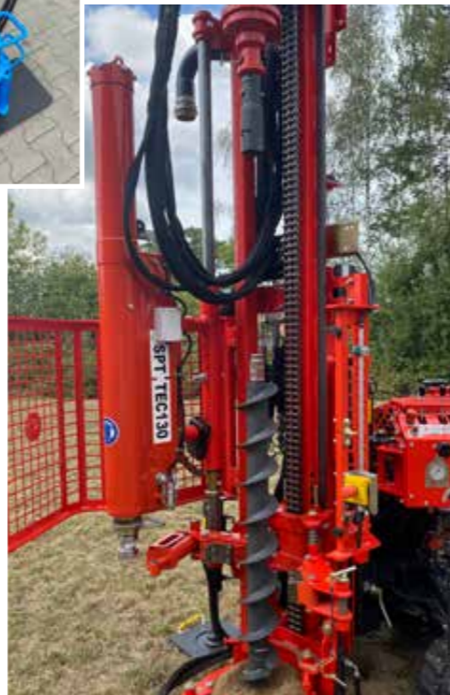
Geologische Sondierung mit der Rammsondiereinheit oder der Hohlbohrschnecke sind im Wechsel möglich
