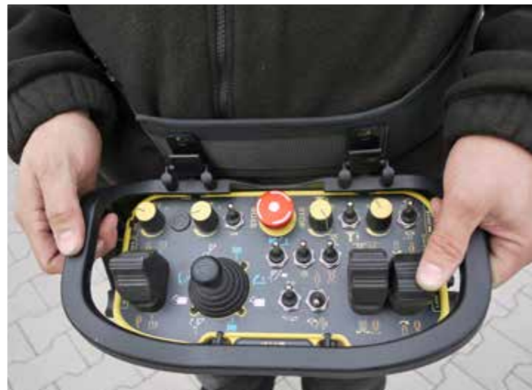
Fernbedienung für Fahren und Bohren (optional)
