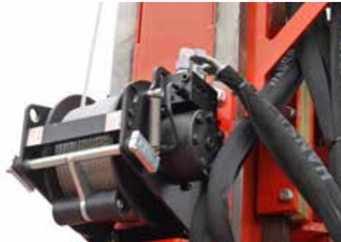
Seilwinde mit 500 kg oder 1.000 kg Zugkraft (optional)
