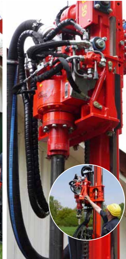
2-stufiger Spülbohrkopf mit Ausschwenkfunktion am B 50
