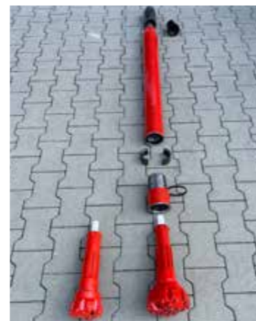
Imlochhammer mit verschiedenen Bohrkronen
