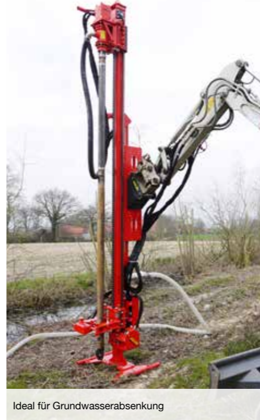
ADLER-Getriebebohrkopf mit Einlass für Filterrohre
