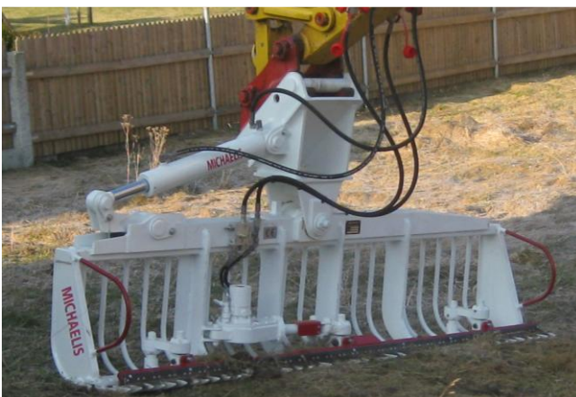
Foto: Standard Mähkorb M 2500 SG für Kompakt-Bagger, hier mit Sonderausstattung „Schwenkzylinder“ (Schwenkbereich ca. 30 °)
