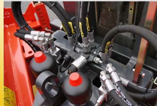
Elektrisches Umschaltventil mit Überlastsicherung durch zwei Druckbegrenzungsventile und Stickstoffblase
