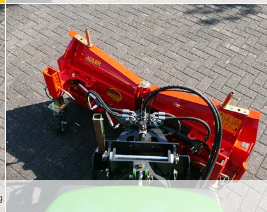
Hofladeraufnahme mit Niveauequaler und Abstellstütze
