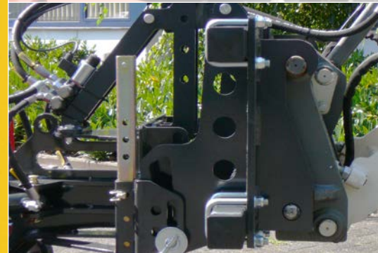
Hofladeraufnahme mit Niveauequaler und Abstellstütze
