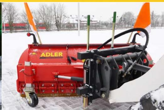
Universalaufnahme mit hydraulischer Verschwenkung (mit zwei Hydraulikzylindern)
